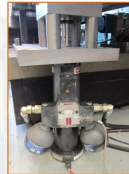
Vérins hydrauliques de capacité 15 kN à 150 kN et de course dynamique allant jusqu'à 250 mm : essai de traction, compression, vibratoire, endurance
