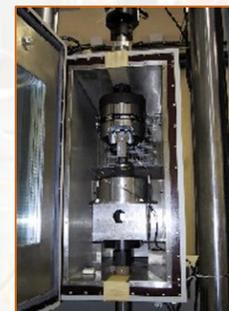
Machine de caractérisation dynamique / fatigue avec enceinte thermique
